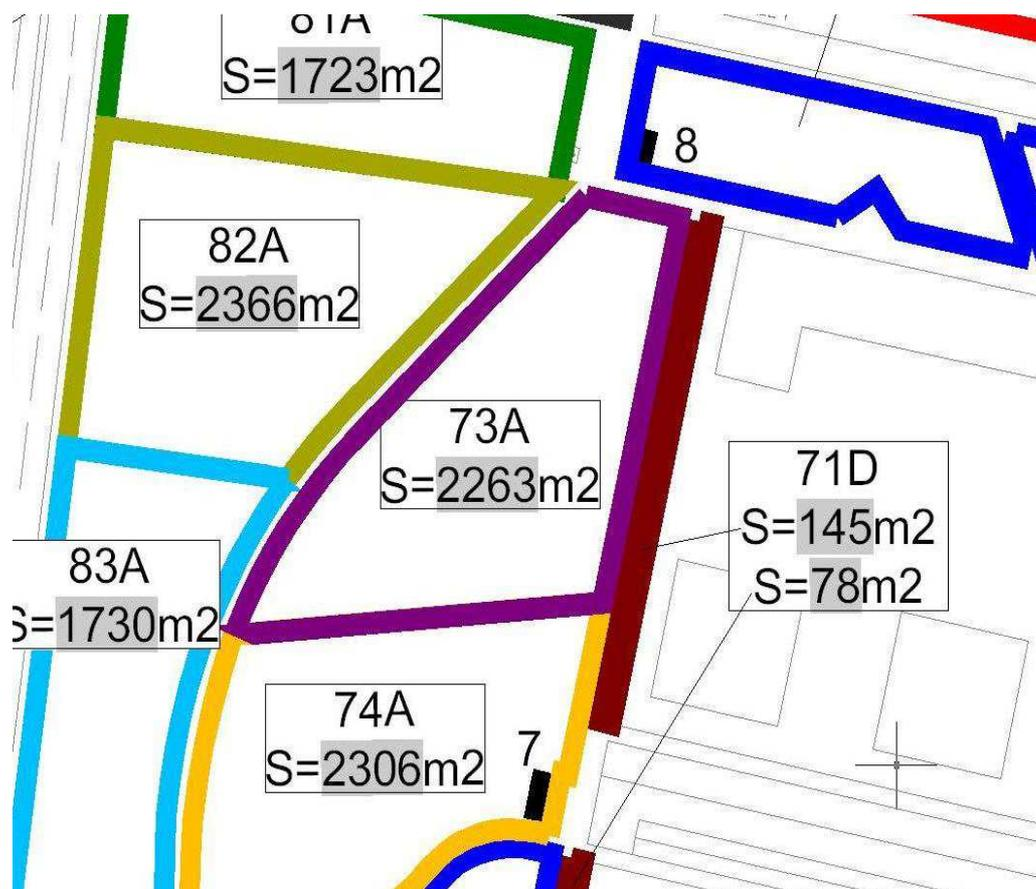
Donde el primer dígito o letra indica el armario de riego, el segundo dígito o letra indica el sector y el tercero si es aspersores (A), difusores (D) o goteo (G).
